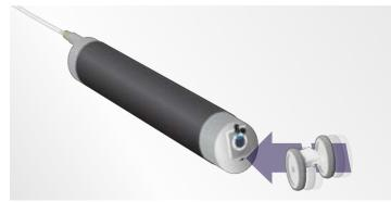
1. INSTALL PACKER'S FRONT WHEEL ASSEMBLY
